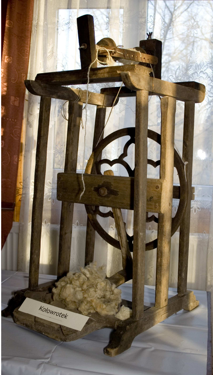
Kołowrotek — urządzenie służące do wytwarzania przędzy z włókien.
