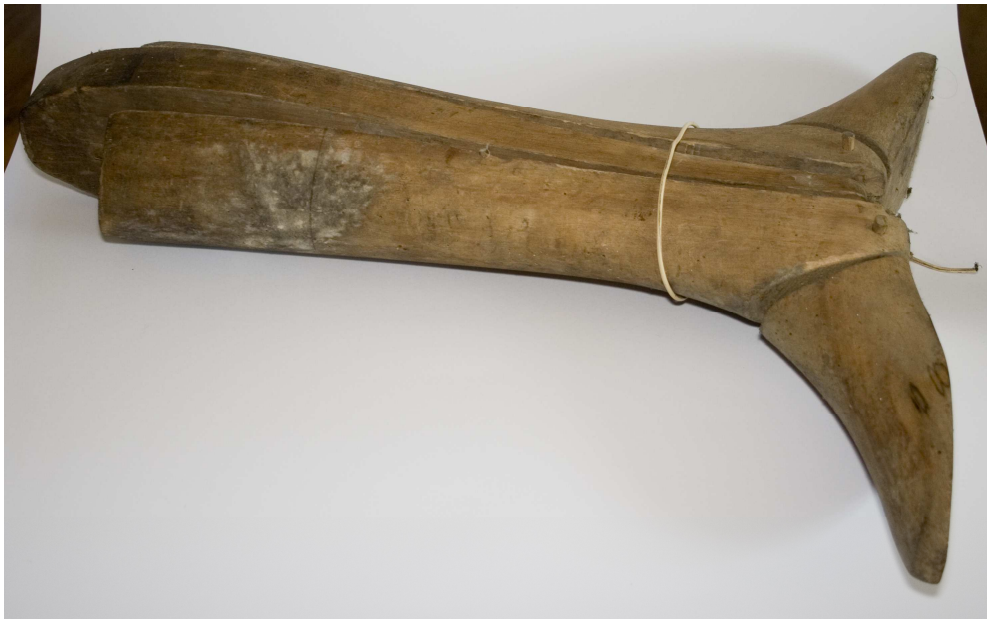
Prawidło — czyli forma do wyrobu butów.
