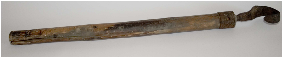
To narzędzie służyło do wyrobu drewnianych łyżek
